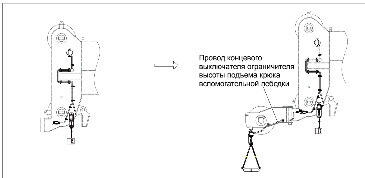
Рисунок 4-16 Электрическое соединение одиночного блока на оголовке стрелы
