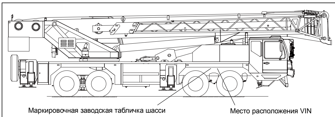
Рисунок 1-4 Место расположения маркировочной заводской таблички шасси
