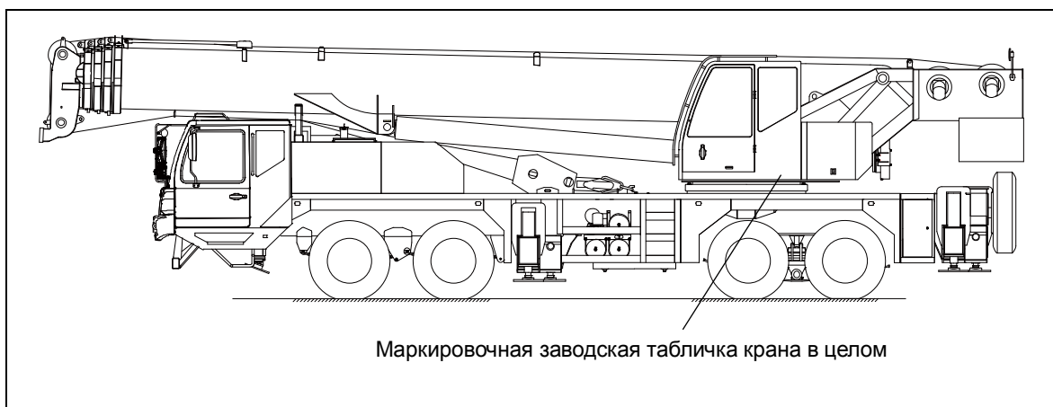
Рисунок 1-3 Место расположения маркировочной заводской таблички крана в целом
